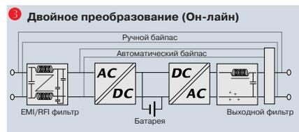
**Преимущество:** Самая совершенная топология, нагрузка непрерывно защищена от любых типов помех, непрерывная регулировка выходящего напряжения (амплитуда и частота), и непрерывность сервиса, благодаря байпасу.
